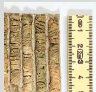
Sorgfältige Kontrolle der Hölzer anhand von Bohrkernentnahmen nach der Imprägnierung gewährt ein Höchstmaß an Haltbarkeit.
