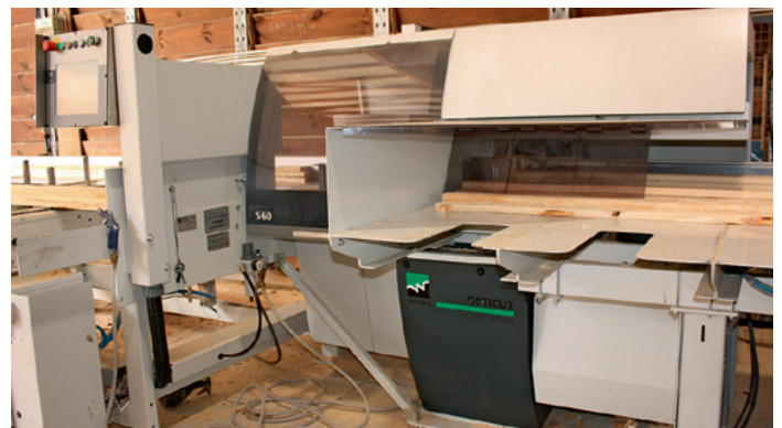
Nach der Kappung: Die Kappsäge bei Holz Mayer verfügt über das Paket „Abschieben aus dem Schnitt“
