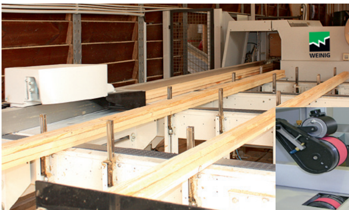
Am Einzugsstisch der Dimter-OptiCut S 60 befinden sich für die Beschickung Querkettenstränge mit drei Klinkenreihen, im kleinen Bild die Signierrollen
